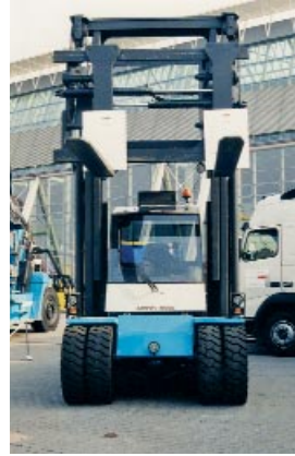
Gabelstapler mit einem hinter den Vorderrädern angebrachten Hubmast
