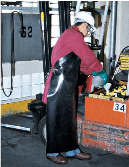
Persönliche Schutzausrüstung bei Instandhaltungsarbeiten an Batterien
