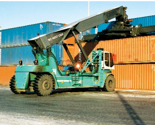
Teleskopstapler mit Spreader (Reach Stacker)
