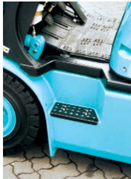
Günstige Trittgestaltung: Auch beim Absteigen sichtbar
